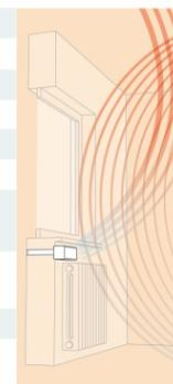
Устанавливается в стене между радиатором отопления и подоконником. За счет разницы в давлении воздушный поток с улицы по каналу в стене затягивается в помещение, а встроенный в клапан фильтр очищает воздух и защищает от шума, пыли и насекомых. Поступая на радиатор отопления, свежий воздух смешивается с теплым и не требует дополнительного нагрева. Есть функция регулировки объема поступающего воздуха.
